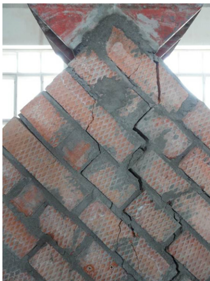
Рисунок 5. Продольные трещины в зоне нагружения образца
