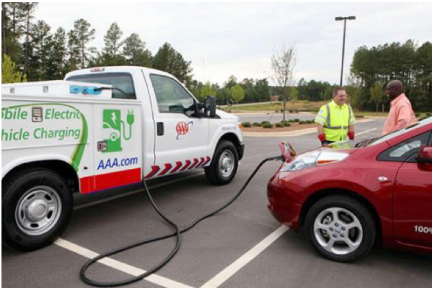
Рис. 3. Мобильная зарядная станция на базе грузовика.
