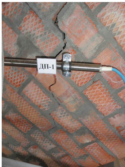
Рисунок 4. Развитие трещины от центра фрагмента к углам сжатой диагонали образец № 2 серия ОК-1Эс
